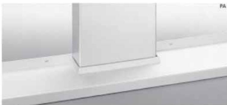
**PA** – Pfeilerausklüngen als Aussparung aus einem Stück mit verschweißter senkrechter Aufbördelung A 3. Alternativ mit Stoßfuge der Fensterbänke an der Ausklüngen, und mit U-förmiger Aufbördelung A 4.
