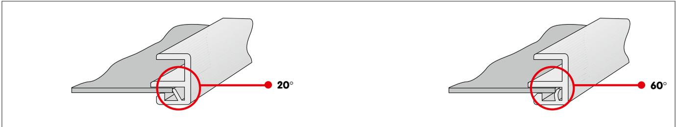
Eine 3 m lange ALU-Fensterbank wird bei Erwärmung von 20° auf 60° um 3 mm länger. Der Guntia-Gleitabschluss gleicht dies aus.
